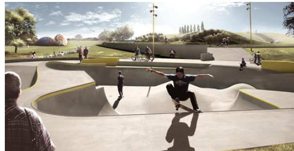
Figur 5: Byomdannelse med indbygget klimatilpasning. Rabalderparkens skatepark fungerer også som regnvandsbassin, og er et eksempel på, hvordan et teknisk kloakanlæg kan give positive sideeffekter
