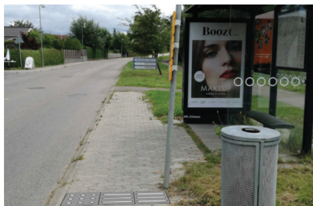
Stoppestedets stander flyttes udfor bussens fordør. Der etableres opmærksomheds- og retningsfelt ved fordøren som forlænges så det er i sammenhæng med den eksisterende naturlig ledelinje.
