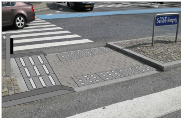
Opsætning af akustiske signaler, etablering af retningsfelt med 6 cm lysning og opmærksomhedsfelt med 0-lysning.
